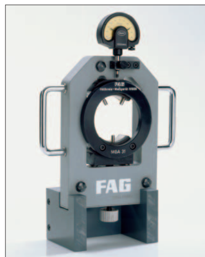
FAG rullekransmåleapparat MGA 31 til indstilling af radialslør i cylindriske rullelejer med adskillelige yderringe.
