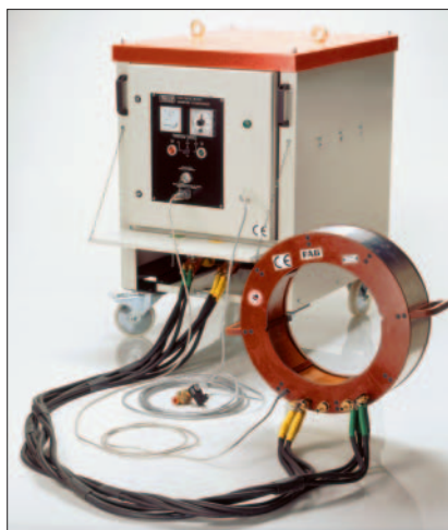
Demontagespoler til lavspændning med transformator beregnet til demontage af inderringe på cylindriske rullelejer
